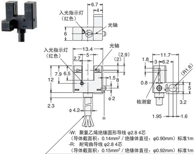
\* 这个突起用于防止旋转使用。安装时, 请开凿 $\phi$ 2.1~2.3mm的孔 (固定) 使用。
